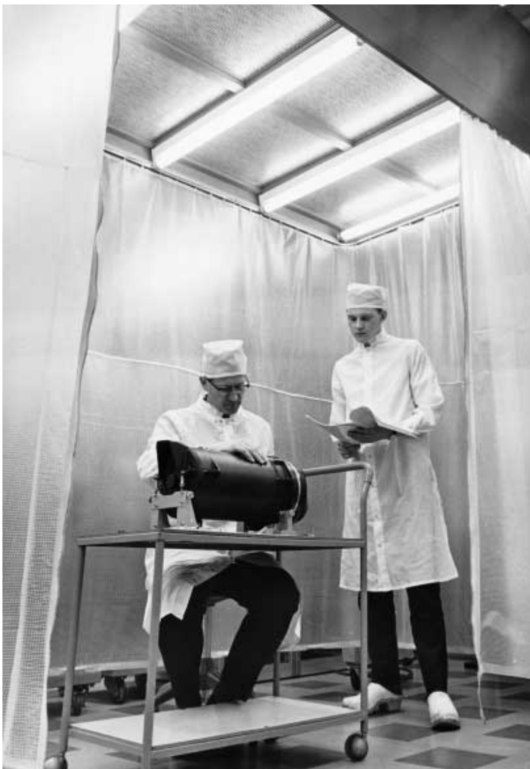
Justeringsarbete utförs i rumsklass 4 under en "miljöbaldakin" placerad i en provningsverkstad av miljöklass 3. Sittande vid flyglägesgivaren, Knut Andersson.
