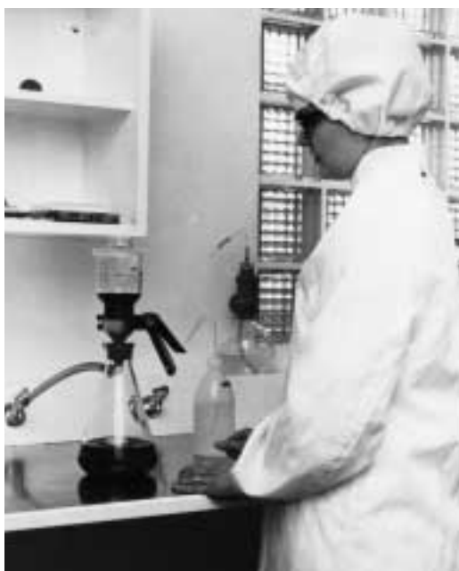
Filtrering av hydraulolja för manuell mikroskopering och statistisk beräkning av föroreningsnivån.
