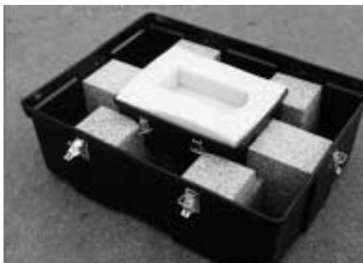
Specialemballage utvecklat av FFV Underhåll för gyrotransporter till oljeplattformar.
