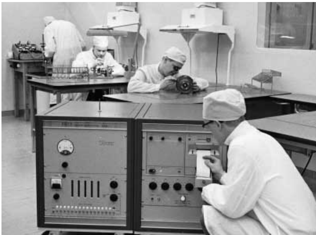
Laboratoriepersonal utför kontroll av luftburna partiklar i en verkstadslokal av klass 4 med den första generationen automatiska partikelräknare av typen Royco Particle Counter Model 200 A.
