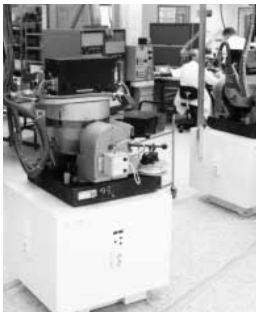
IME (TN-plattformar) för fpl JA 37 under autotest monterade på en "störpir".
