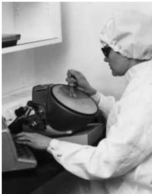
Manuell partikelräkning för statistisk bearbetning var en omständlig procedur innan det fanns automatiska räknare även för vätskor.
