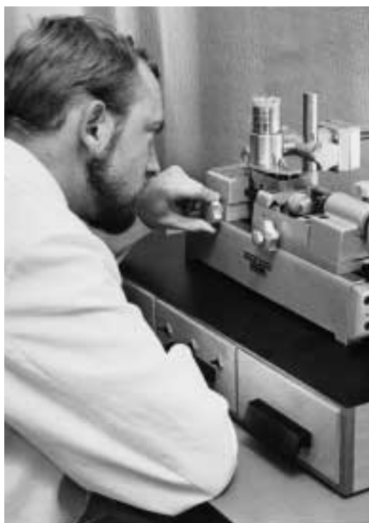
Lars-Ivan Lidén provar rullningsfelet på en kugg-axel till en servokomponent.
