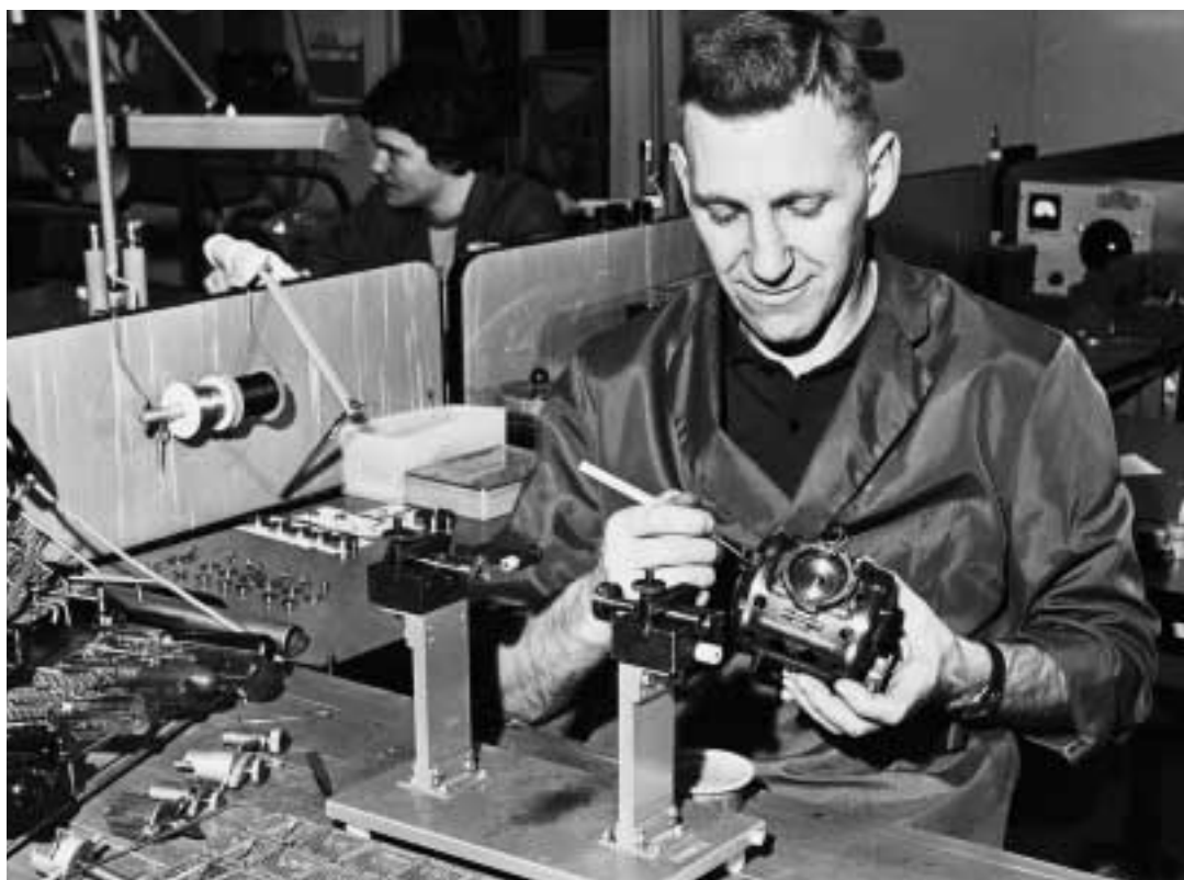
Interiör från demonteringen, Gunnar Rydén skyddoljar en kardan till flyglägesgivare 25, i bakgrunden Roland Fransson.
