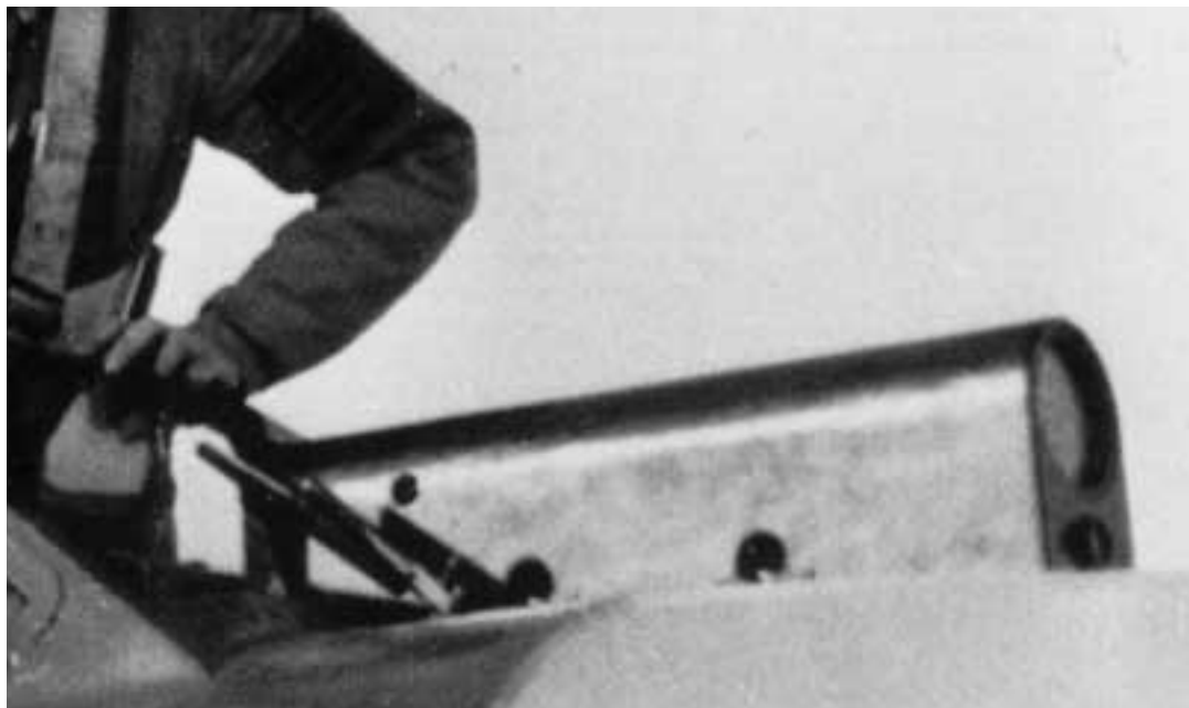
Mörkertillsats monterad på plats, framför vindrutan, på en Venom. Foto från Krigsarkivet
