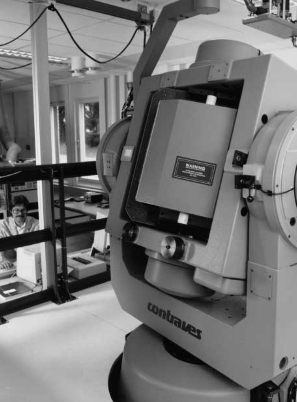
Treaxligt datorstyrt svärgbord för dynamisk provning av TN-system. Vid styrdatorn Kenneth Berggren
