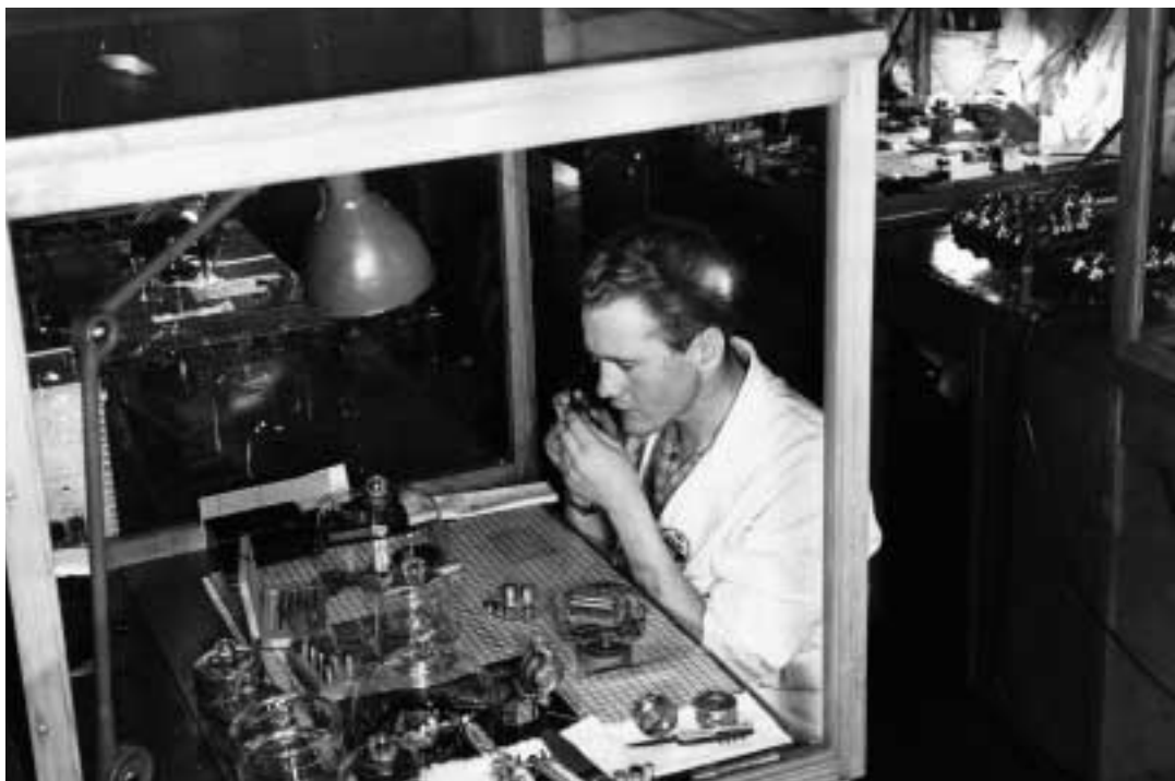
Sivert Karlsson (senare Identeg) granskar kullor till upphängningslager till ett pneumatiskt kursgyro. I bakgrunden funderar instruktören Sven "Mudde" Fredriksson över ett balanseringsproblem med ett pneumatiskt horisontgyro.
