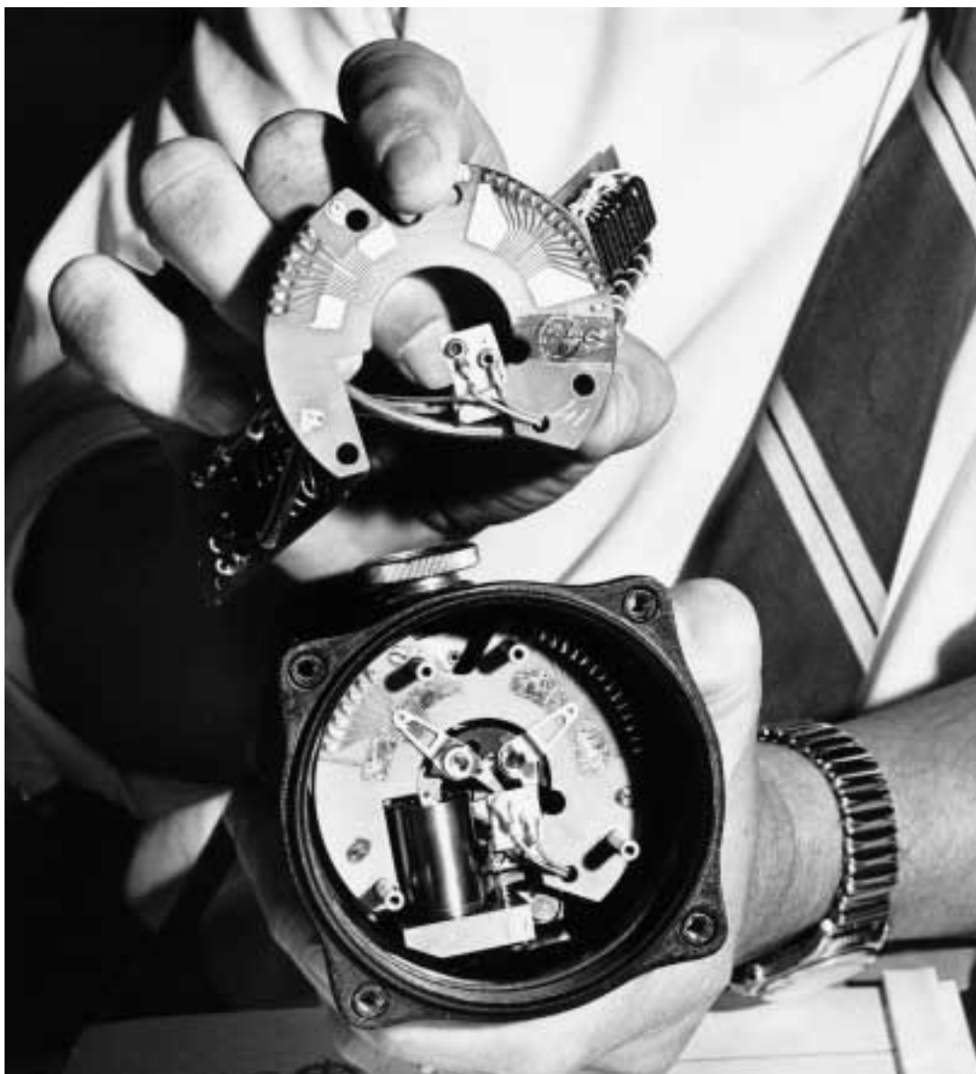
Svängindikator med givarfunktion för girkompensering vid raketskjutning. Överst den kompletta omkopplingsenheten och nedtill är enheten inmonterad i en delvis monterade svängindikator som på bilden hålls upp och ner. Foto: Lennart Sjösvärd
