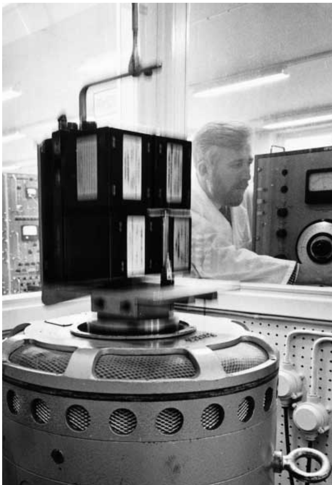
Vibrationsprovning av en moderator till bränslesystem hkp 3 och 4. Genom glasrutan syns Hawker-Siddeleys förbindelseingenjör Ian Gow.
