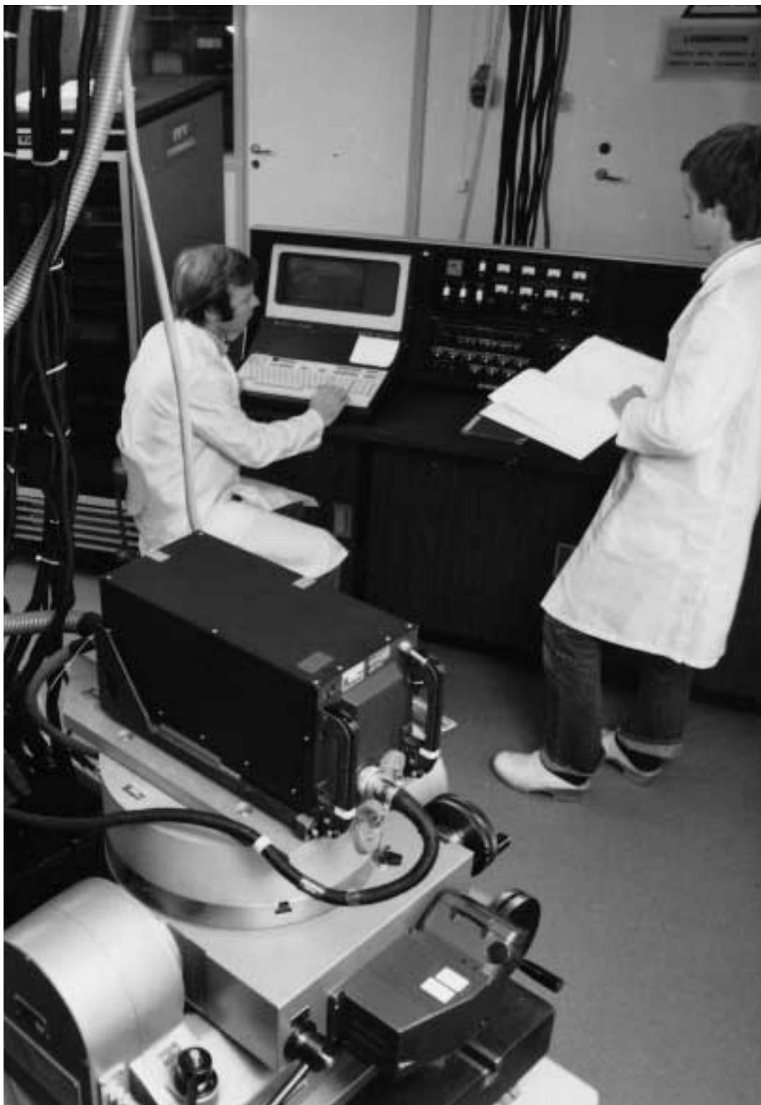
Mottagningskontroll av TN-plattformar i den första TN-verkstaden. Från vänster Håkan Palm och Lars-Gunnar Lundén.
