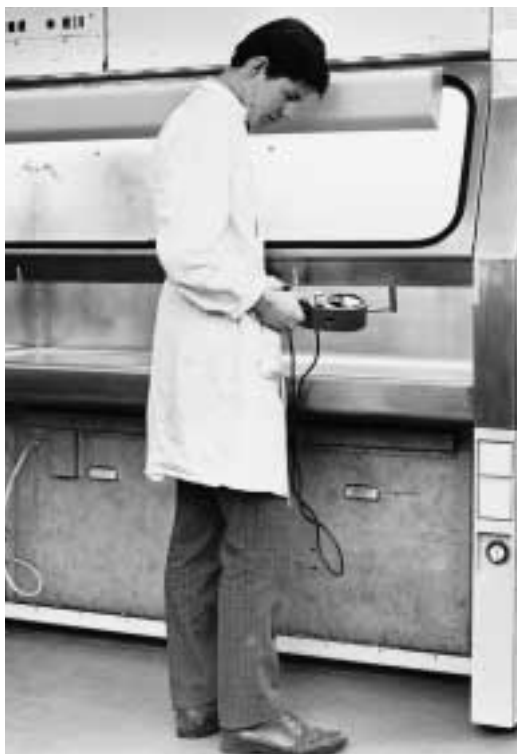
Torbjörn Edberg mäter under förmonteringen luftflödet i en säkerhetsbänk för bakteriologiskt arbete.
