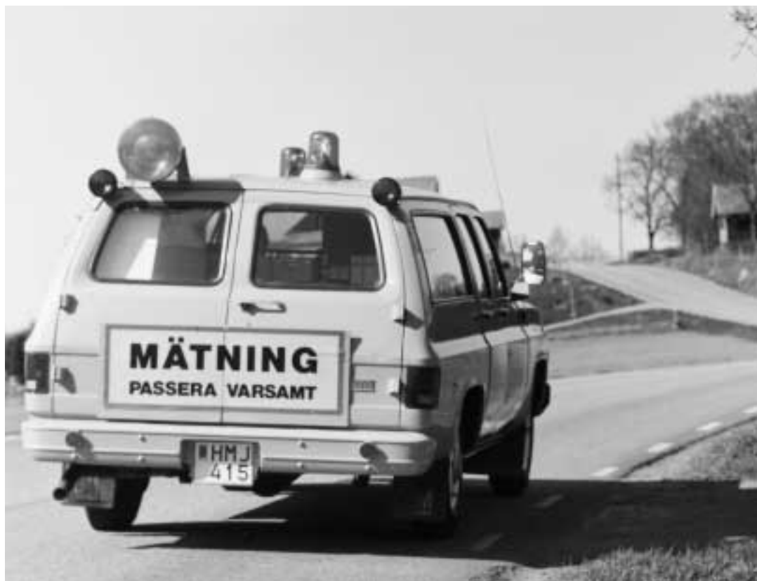
Vägverkets bil mäter vägens kurvatur med hjälp av Drakens gyroplattform.
