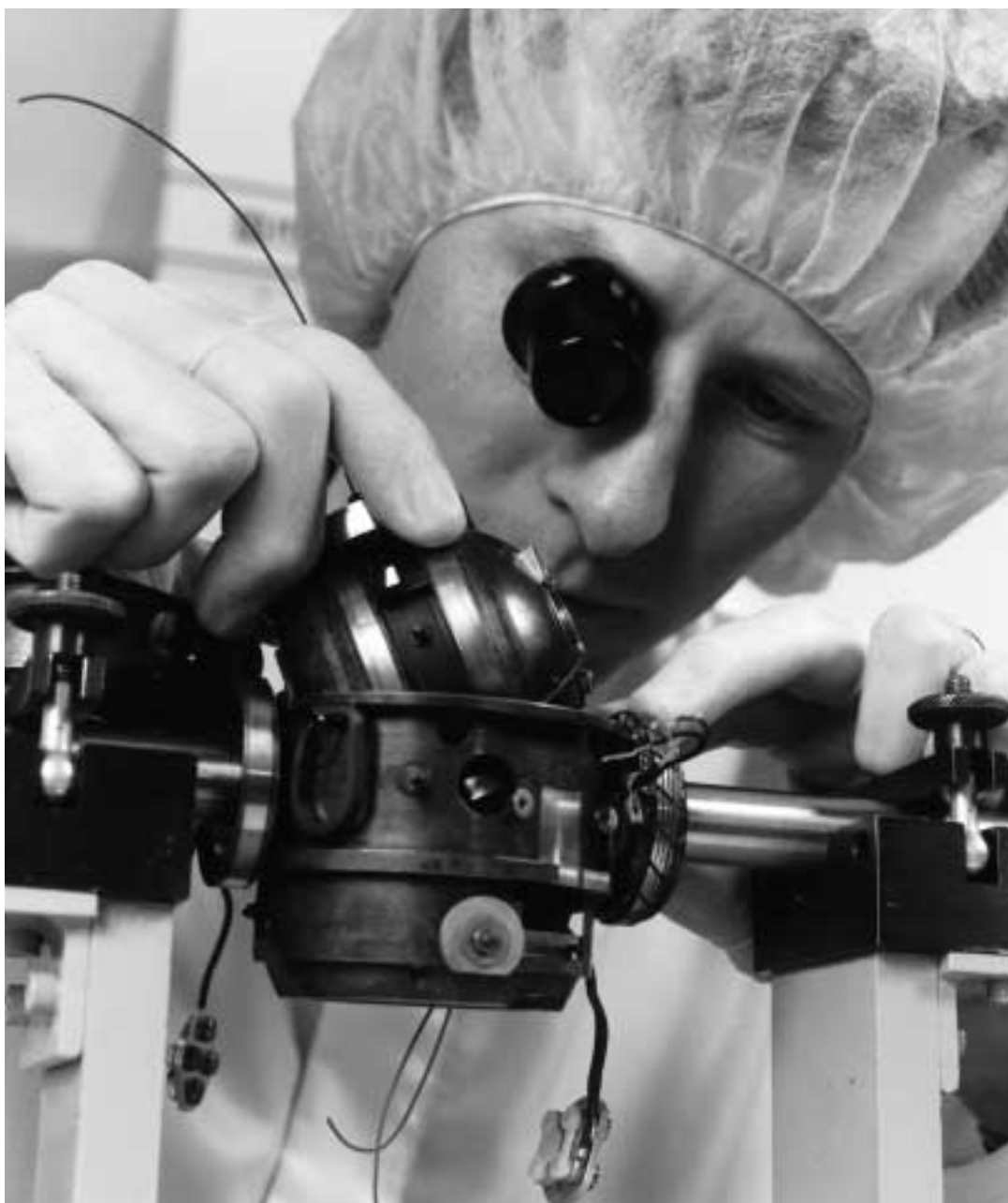
Roger Andersson monterar ett gyrohus i en kardan till flyglägesgivare 37 i rumsklass 5.
