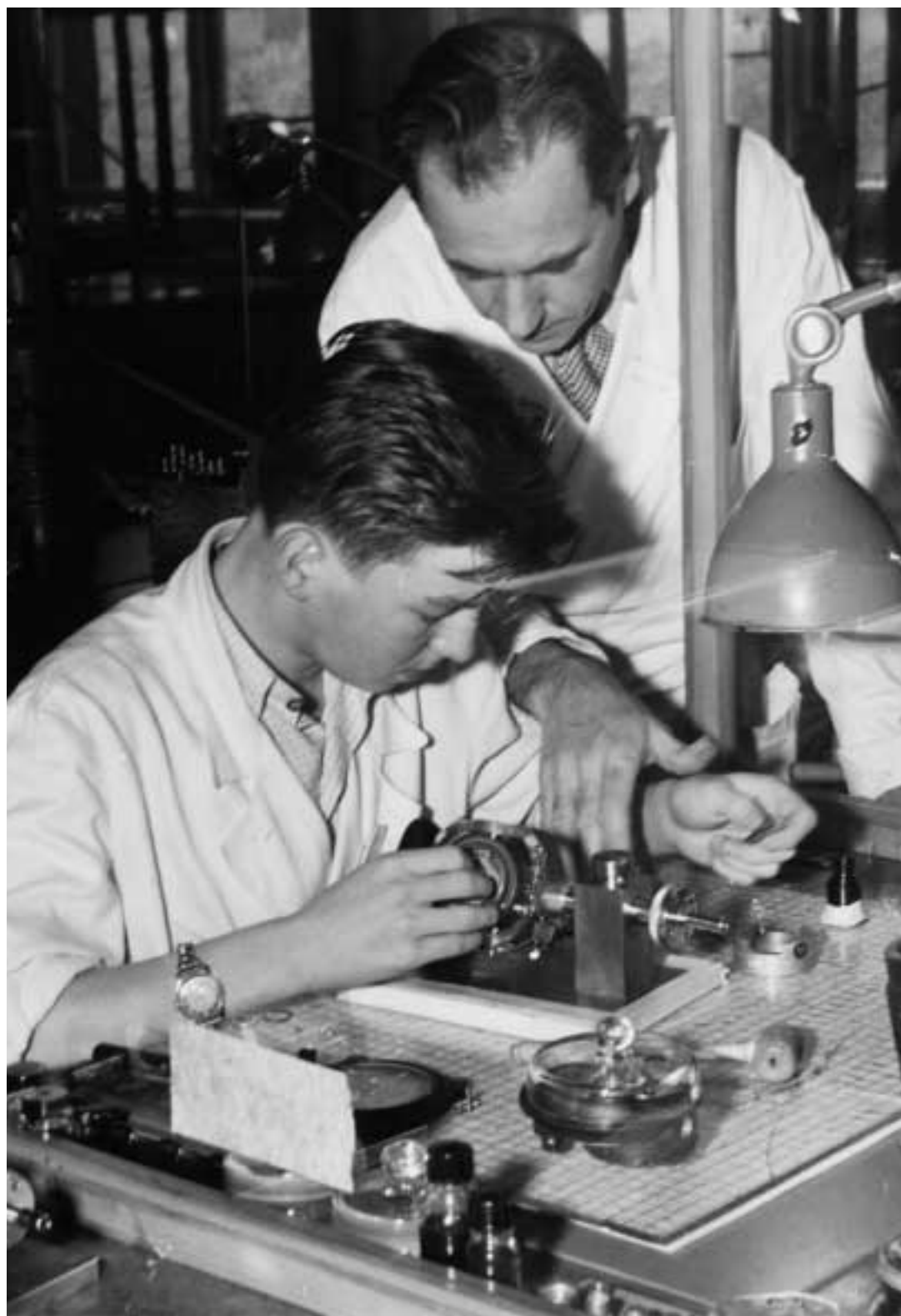
Instruktören Sven "Mudde" Fredriksson hjälper lärlingen Lennart Staaf med något problem vid balansering av ett pneumatiskt horisontgyro.
