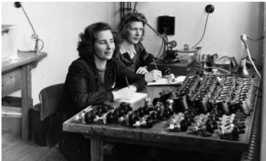
Två av IP:s damer, Solvig Andersson (gift Kilman/ Gustavsson) och Irene Andersson (gift Liljebäck) i arbete med leveransprovning. Närmast kameran AGA:s reduceringsventil TM-1290 för syrgas, de fyra andra raderna apparater är tryckregulator AGA TREA-25. Tryckregulatorn, som matades via en reduceringsventilen, doserade rätt mängd syrgas till piloten i förhållande till flyghöjden.
