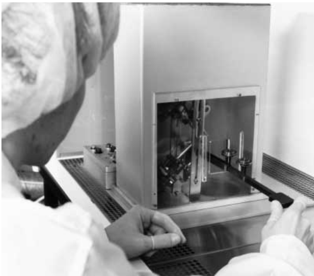
Mona Granat tvättar kullager i en vertikalt strömmande miljöbänk som i denna omgivningsmiljö ger rumsklass 7.
