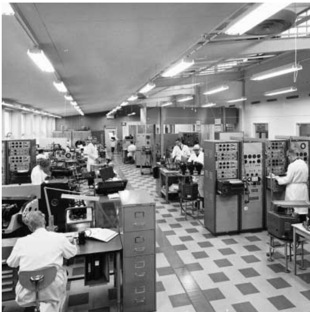
Slutprovningen i rumsklass 3 av instrumentmateriel som monterats i klass 4-7 men nu så försluten att provning kan ske i lägre miljö
