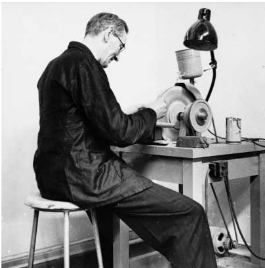
Kilger slipar en linsfattning
