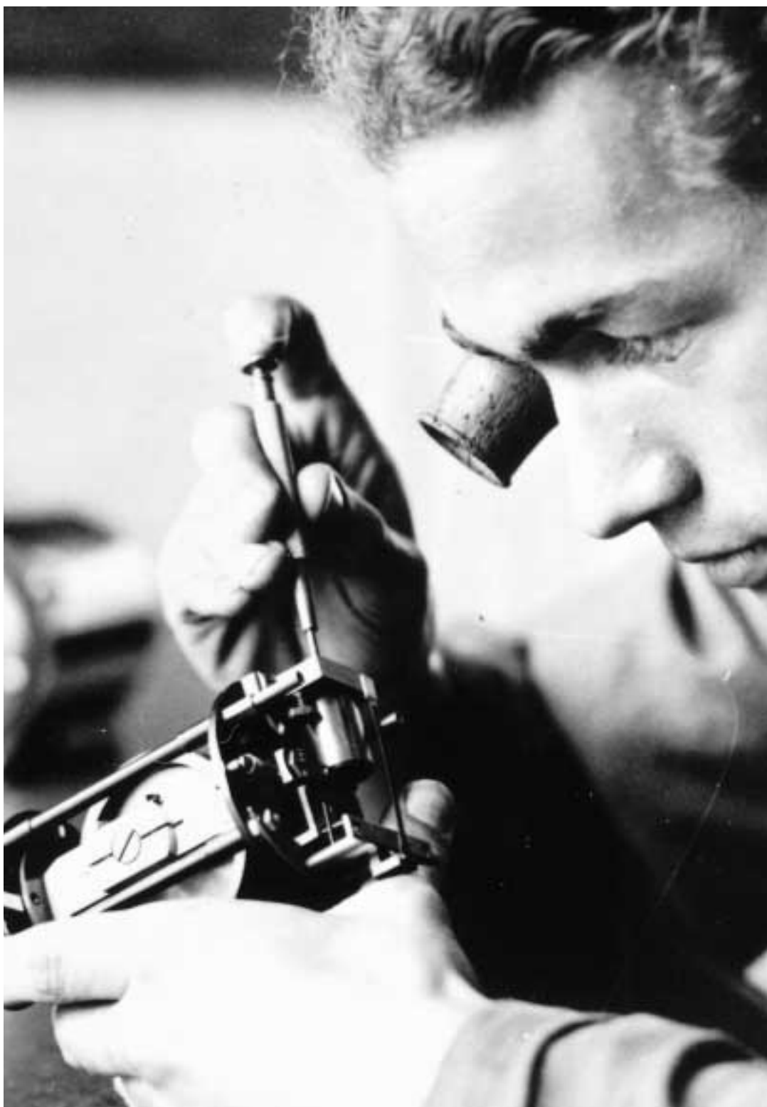
Justering av dämpningen på en girindikator år 1938, instrumentmakaren heter Astor Lindström. Foto ur Astor Lindströms efterlämnade samlingar
