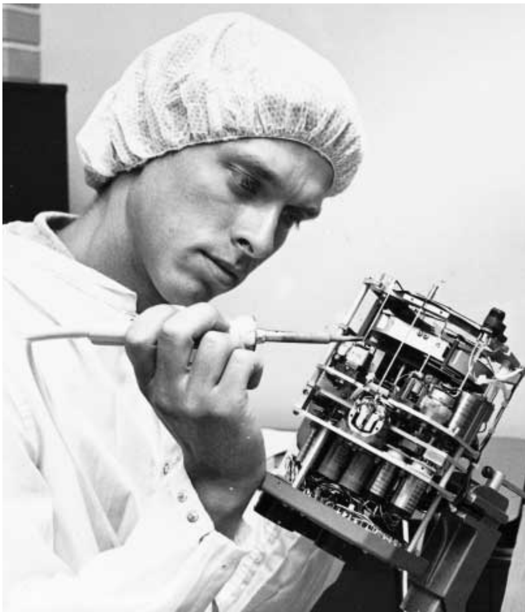
Per-Olof Pettersson i arbete med en flyglägesindikator, rumsklass 4.
