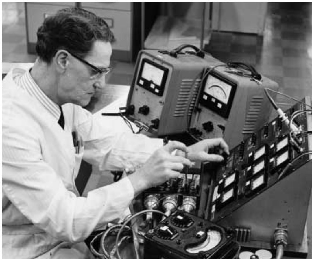
Harry Köpsén trimmar en förstärkare till styrautomat 04, fpl 32.
