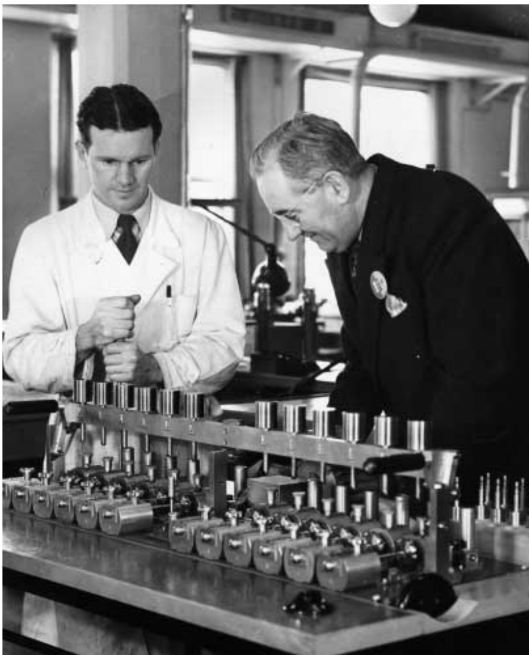
Sista handen läggs vid den tolvspindliga läppningsmaskinen för kullagerskålar till luftdrivna gyroinstrument. Franz Kilger till höger och John Ohlsson till vänster. Foto: Göte Jakobsson
