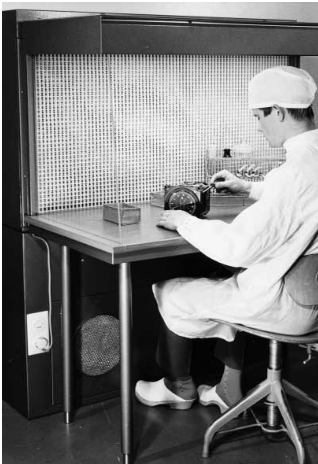
Lennart Burlin arbetar i en renluftbänk av CVM:s fabrikat avsedd för verkstadsbruk inom försvaret och dess underleverantörer.
