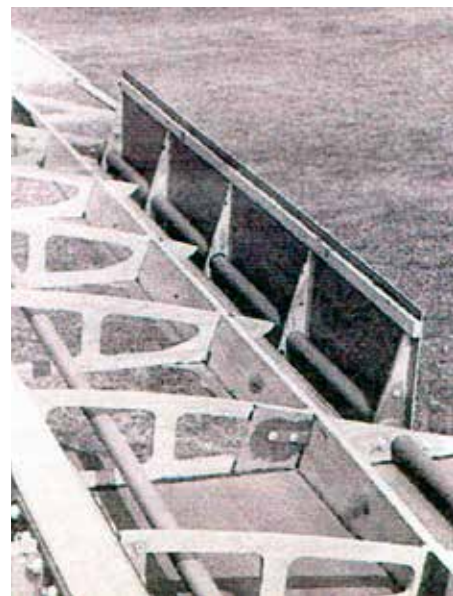
Bakkantbromsar, något förstörade på BJ-1b Duster jämfört med BJ-1 Dyna-Mite.
