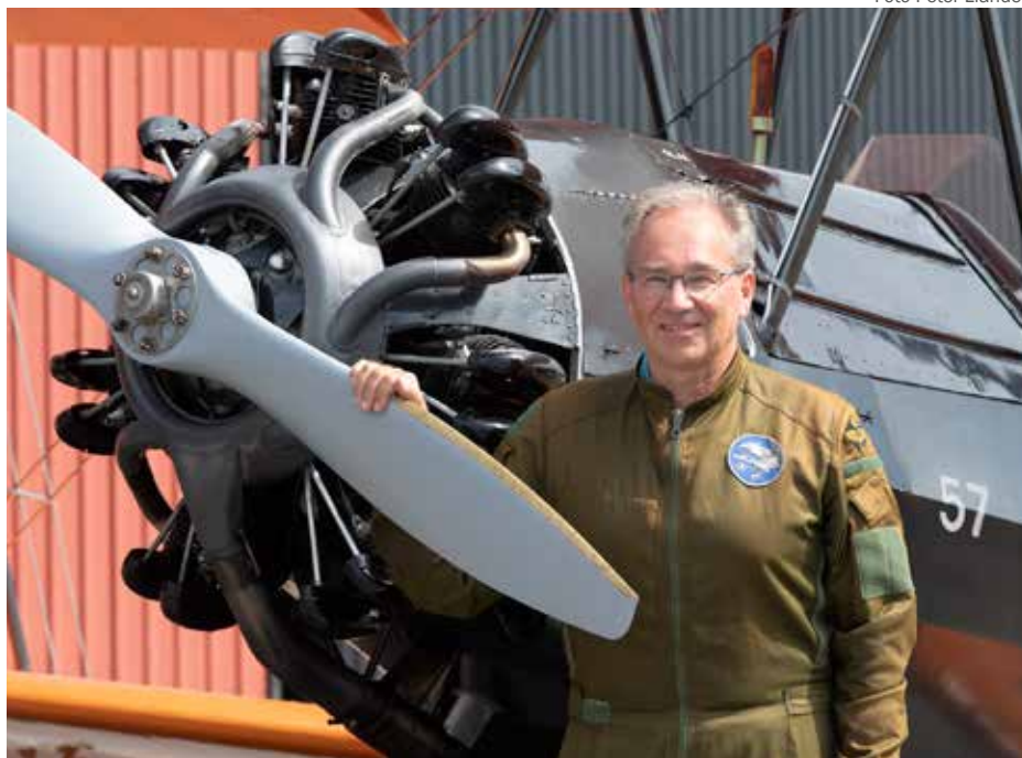
En mycket glad Joakim Westh poserar vid Sk 12:ans motor – en 150 hk Siemens Halske Sh 14a, som ger maskinen en toppfart om 168 km/tim.
