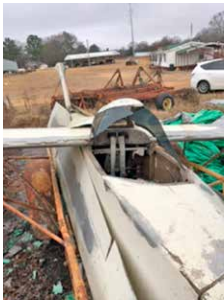
Kroppsspant och longeronger. Kroppen byggdes på en furuplanka.
