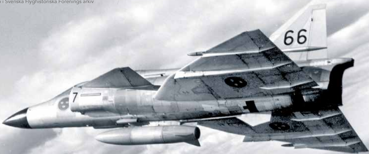
Saab SK 37 Viggen utrustad med en Volvo Flygmotor RM8. Dragkraft 65 kN, med efterbrännkammare 115 kN.
