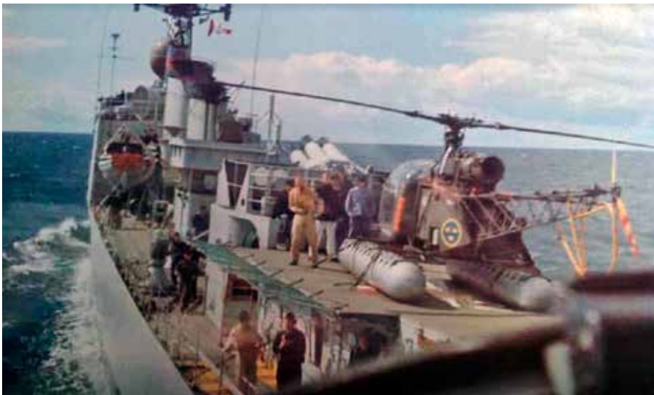
På bilden syns en HKP 2 Alouette II parkerad och surrad med fyra spännband på däck till en fregatt. Det är samma däck som nämns i händelsen nedan. Foto genom artikelförfattaren.
