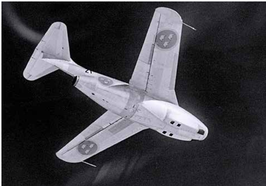
S 29C Tunnan sedd underifrån med kameraöppningarna synliga. Foto i F 21:s arkiv.
