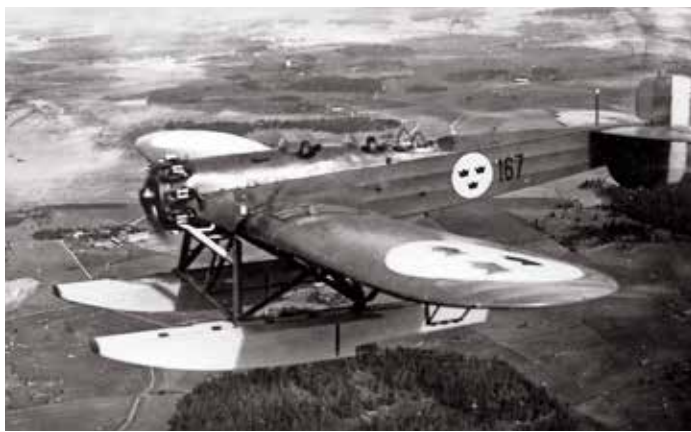
S 5A, Heinkel HE 5/t Hansa med flottörer, tillverkad av Centrala Flygverkstaden i Västerås (CFV). Foto i Lennart Anderssons arkiv.
