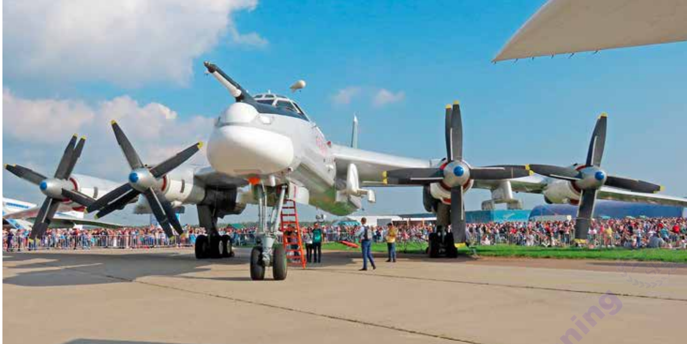
Bombplanet Tupolev Tu-95MS. Notera vapenbalkarna, under vingen intill flygkroppen, för Kh 101/Kh 102. Foto Lennart Samuelsson.
