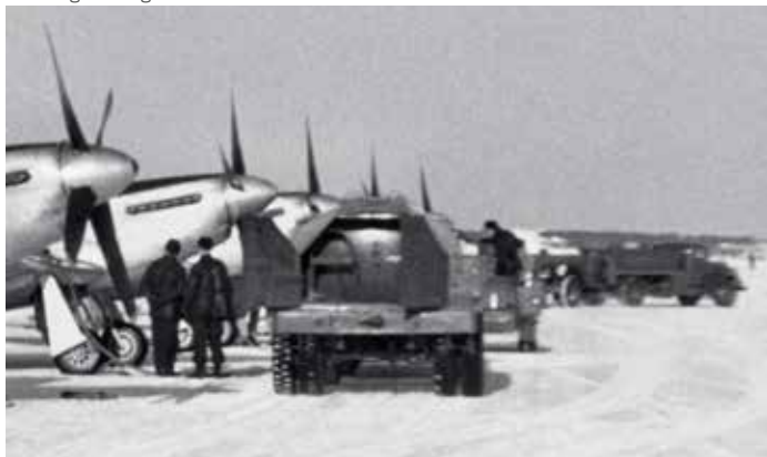
De här kärrorna har försetts med dolly framtill och dras av Volvo-tankbilar som tankar J 26:or från F 20. Förmodligen pumpades bränslet i tankkärrorna över till tankbilarna allt eftersom.
