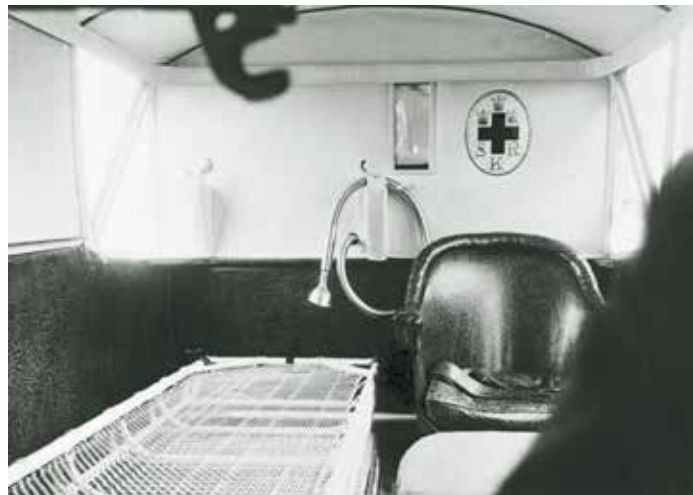
Ambulansflygplan nr 1, Junkers F 13: Med kron- och rödakorsmärkning, på flottörer vid provflygning hos AB Flygindustri i Limhamn. Planet levererades till Boden i maj 1928. Interiör sedd bakifrån. På hållaren för den övre baren hänger en talslang för kommunikation med besättningen. Demonstration av inlyftning av bår i samma Junkers F 13. Bårburna patienter lastades in genom ett av sidofönstren.
