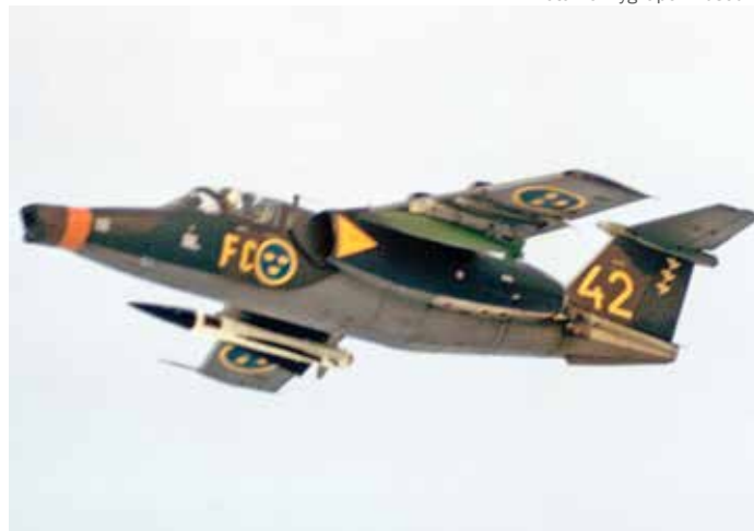
Ovan: Robot 05B, här under en AJ 37 Viggen. Längst fram syns det stora "ögat" med TV-målsökaren innanför. Ovan till höger: Något suddig bild av 60010 FC-42 under skjutprov med RB 05A (under höger vinge) i Vidsel 1970. Under vänster vinge hänger en bomb (grön) av typ Mk 82, vikt ca 225 kg. Skyddsplåten för kamerafönstret ser ut att vara borttagen. Bilden publicerades inte i boken om Saab 105.
