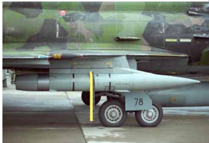
Saab 105 Weapon Trainer planerades även kunna förse med motmedelskapsel KB. Den bars annars av AJ 37-familjen och S 35E "spanings-Draken", och kunde laddas med såväl "facklor" och remsor.
