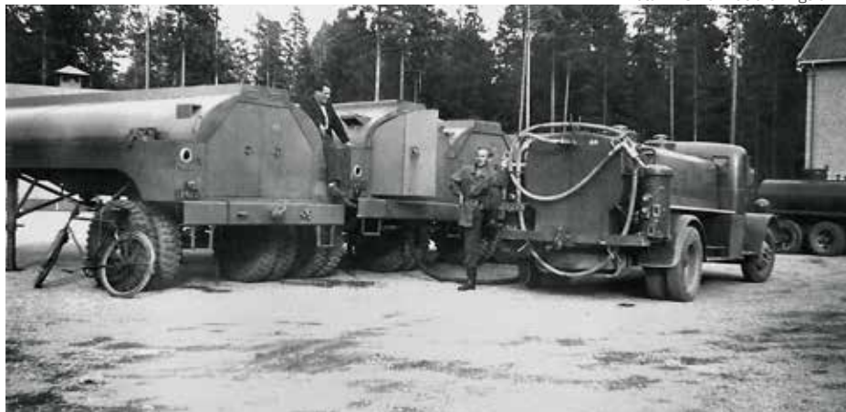
En av F 18:s tankbilar fylls på från en av de amerikanska 7,5 m 3 påhängstankkärror typ F-2B som köptes in 1946–1947 för att transportera bränsle till flottiljerna. Tankbilen i höger bakgrund var en GMC använd som brandbil.
