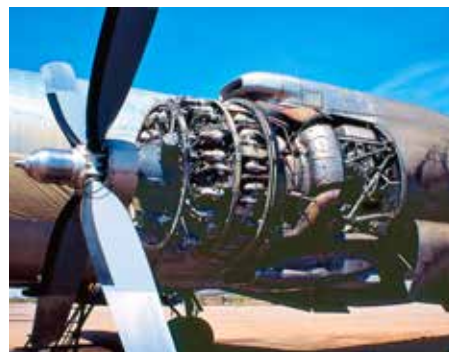
Två DC-7 på Chandler Memorial i slutet av 1980-talet. Ovan till vänster: Denna DC-7B (nummer 45353, byggd för Delta Air Lines) var måhända inte kandidat till någon concours d'élégance . Men likväl en DC-7 med all sin ursprungliga formskönhet! Ovan till höger: En tjugigt blank DC-7C ombyggd till fraktflygplan. Nedan till höger: En av DC-7:ans fyra 18-cylindriga Wright R-3350-turbocompoundmotorer à 2 500 kW (3 400 hk).
