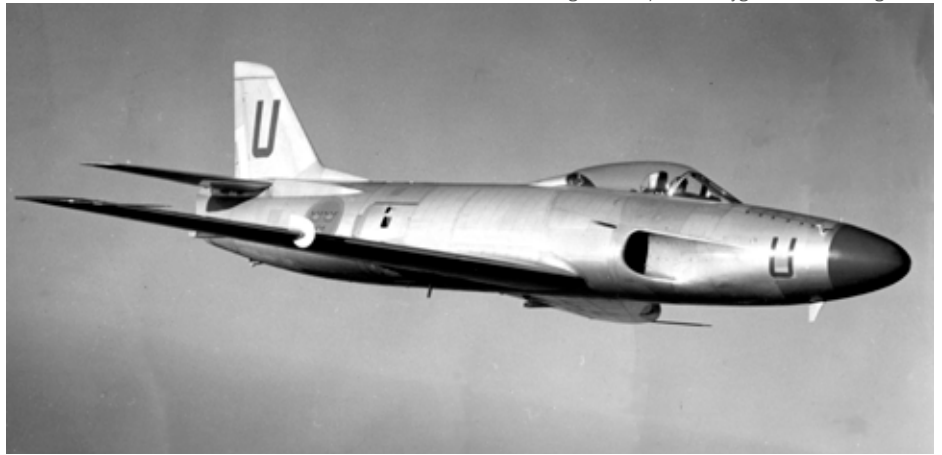
Saab 32 Lansen, prototyp 1, märkt röd U (Utprovning), efter modifiering med nya luftintag.
