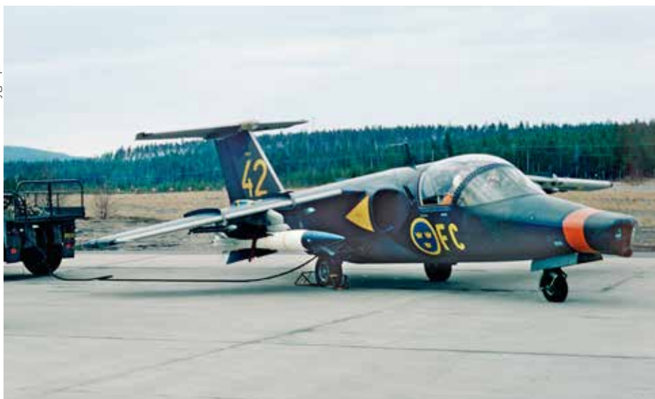
Ovan: Robot 05B, här under en AJ 37 Viggen. Längst fram syns det stora "ögat" med TV-målsökaren innanför. Ovan till höger: Något suddig bild av 60010 FC-42 under skjutprov med RB 05A (under höger vinge) i Vidsel 1970. Under vänster vinge hänger en bomb (grön) av typ Mk 82, vikt ca 225 kg. Skyddsplåten för kamerafönstret ser ut att vara borttagen. Bilden publicerades inte i boken om Saab 105.
