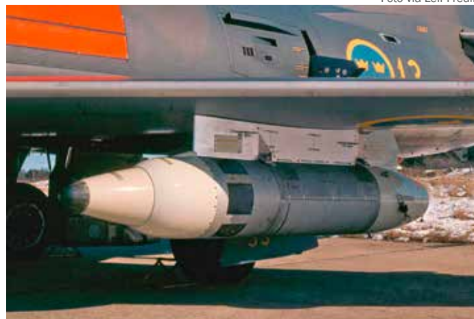
Bulow MBV 2S var en annan typ av målbogseringsvinsch som 105WT skulle kunna bära, här hängd på en J 32D tillhörande Målflygdivisionen.
