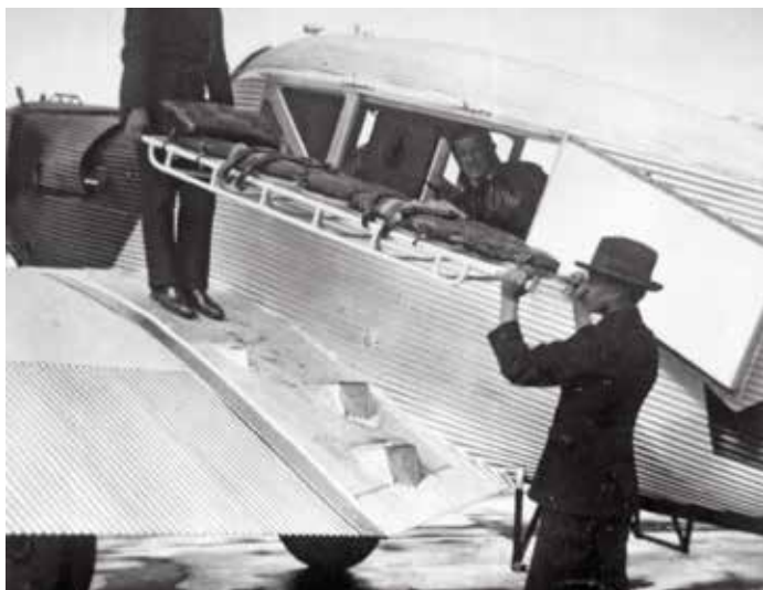
Ambulansflygplan nr 1, Junkers F 13: Med kron- och rödakorsmärkning, på flottörer vid provflygning hos AB Flygindustri i Limhamn. Planet levererades till Boden i maj 1928. Interiör sedd bakifrån. På hållaren för den övre baren hänger en talslang för kommunikation med besättningen. Demonstration av inlyftning av bår i samma Junkers F 13. Bårburna patienter lastades in genom ett av sidofönstren.
