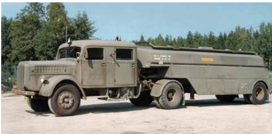
Ovan: Tankbil 11 m 3 som började komma i tjänst 1951 var till en början speciellt anpassad för tankning av Vampire, med tre slangar som drogs ut från en bom. Pump och filter satt i dragbilens hytt. Här demonstreras tankning av J 28B vit Adam från F 10.
