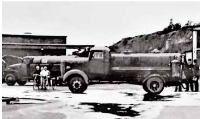
Den ensamma Volvo Terrängtankbil m/42 försågs också med utvändiga filter och var kvar i tjänst hos F 9 till 1966. Bakom den syns en GMC Terrängtankbil m/46, mer känd som Plogtankbil.
