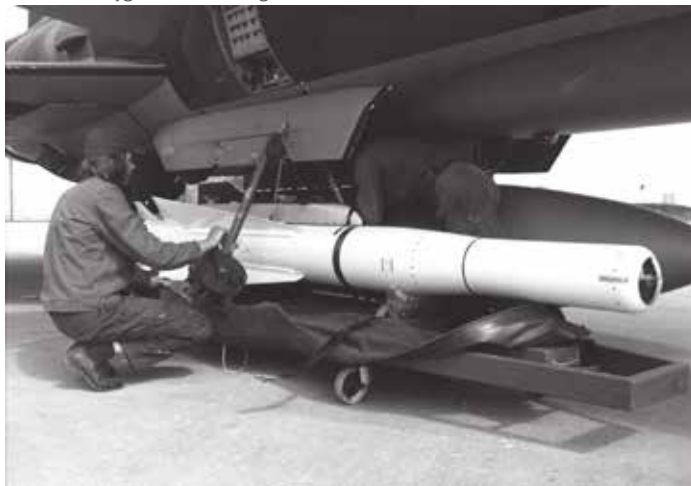
Ovan: Robot 05B, här under en AJ 37 Viggen. Längst fram syns det stora "ögat" med TV-målsökaren innanför. Ovan till höger: Något suddig bild av 60010 FC-42 under skjutprov med RB 05A (under höger vinge) i Vidsel 1970. Under vänster vinge hänger en bomb (grön) av typ Mk 82, vikt ca 225 kg. Skyddsplåten för kamerafönstret ser ut att vara borttagen. Bilden publicerades inte i boken om Saab 105.
